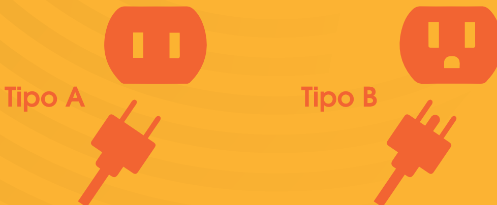
Figura 1: forma de las clavijas (enchufes) tipo A o B
